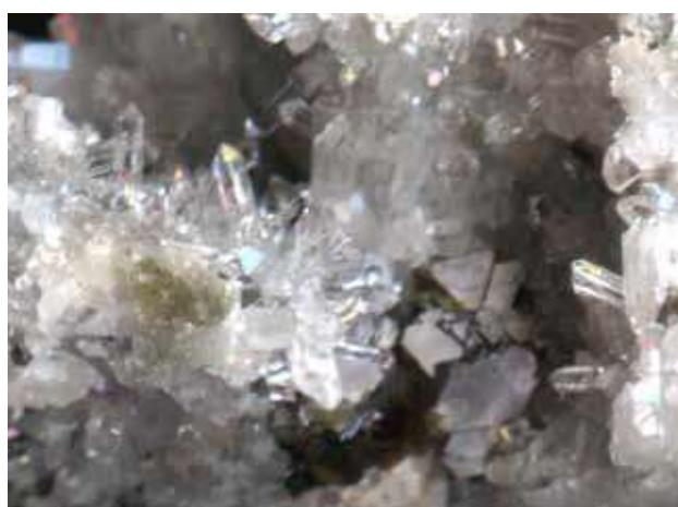
Кристаллы сфалерита и их сростки из центральных частей кварцевых жил, слева: шахта «Орёл»,  $4 \times 2$  см; справа: западное побережье острова,  $3 \times 3$  см. Sphalerite crystals and their aggregates from central parts of quartz veins, left: "Oryol" mine,  $4 \times 2$  cm; right: western coast of island,  $3 \times 3$  cm.
